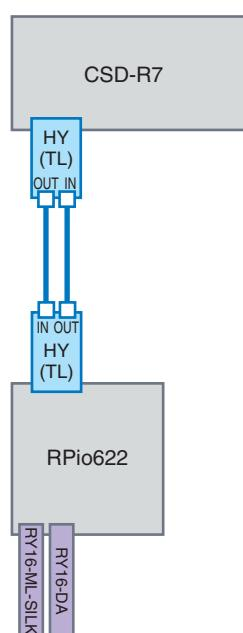
Используйте оптоволоконные кабели для подключения разъемов TWINLAnE IN/OUT на HY-карте, установленной в цифровом микшерском пульте, к разъемам TWINLAnE IN/OUT на HY-карте, установленной в стойке ввода-вывода.
