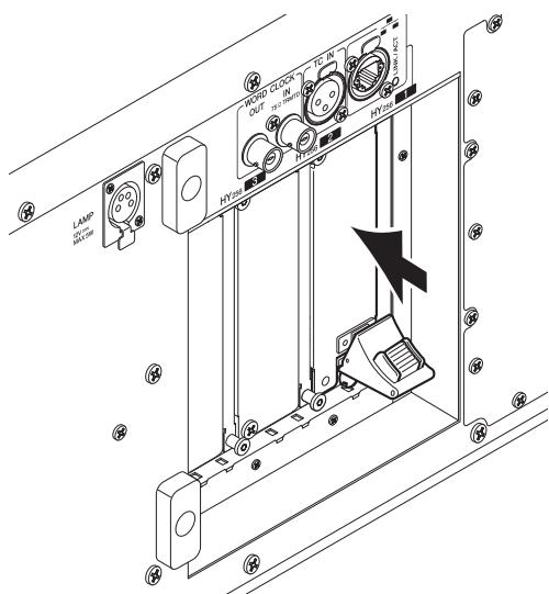
**4. Потяните вверх рычаг установки карты, чтобы зафиксировать ее в гнезде.**
