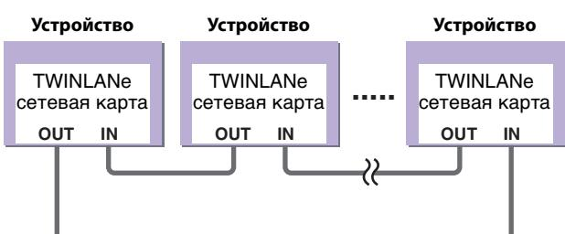
Сеть TWINLANe использует кольцевую топологию, что обеспечивает избыточность при повреждении кабелей. Если кабель в сети по какой-то причине выходит из строя, сигнал будет автоматически перенаправлен, а аудио будет передаваться без прерываний. Даже если устройство в сети неисправно, другие функционирующие устройства продолжат взаимодействие.
