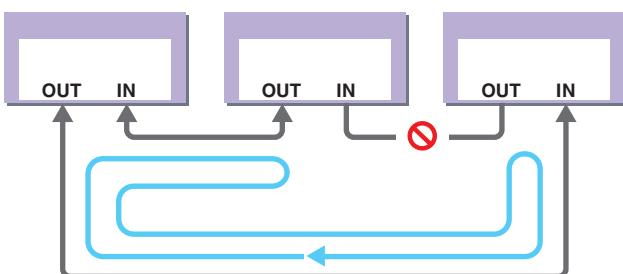
Даже если кабель в одной точке поврежден, сигнал будет автоматически перенаправлен, а аудио будет передаваться без прерываний.
