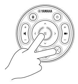
La configuration est terminée une fois que le témoin de statut sur le panneau avant de l'appareil clignote cinq fois en orange à des intervalles de 0,5 seconde.
