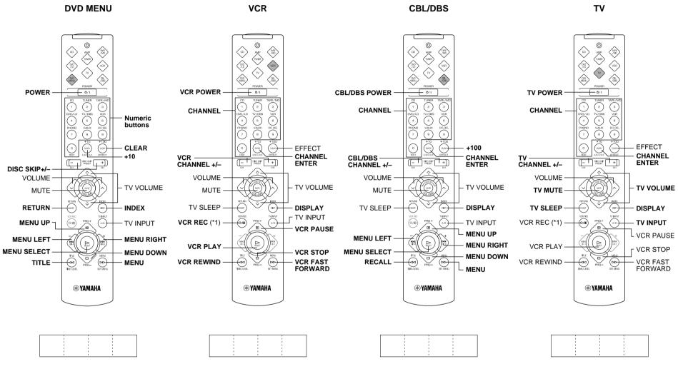
\*1: Press this button twice to start recording. Appuyer deux fois sur cette touche pour lancer l'enregistrement. Diese Taste zweimal drücken, um die Aufnahme zu starten. Tryck två gånger på den här knappen för att börja spela in på videobandspelaren.
