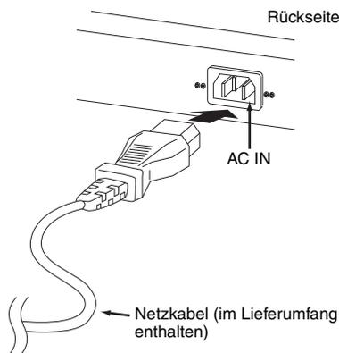
**HINWEIS** Führen Sie diese Schritte in umgekehrter Reihenfolge aus, wenn Sie das Gerät vom Netz trennen möchten.
