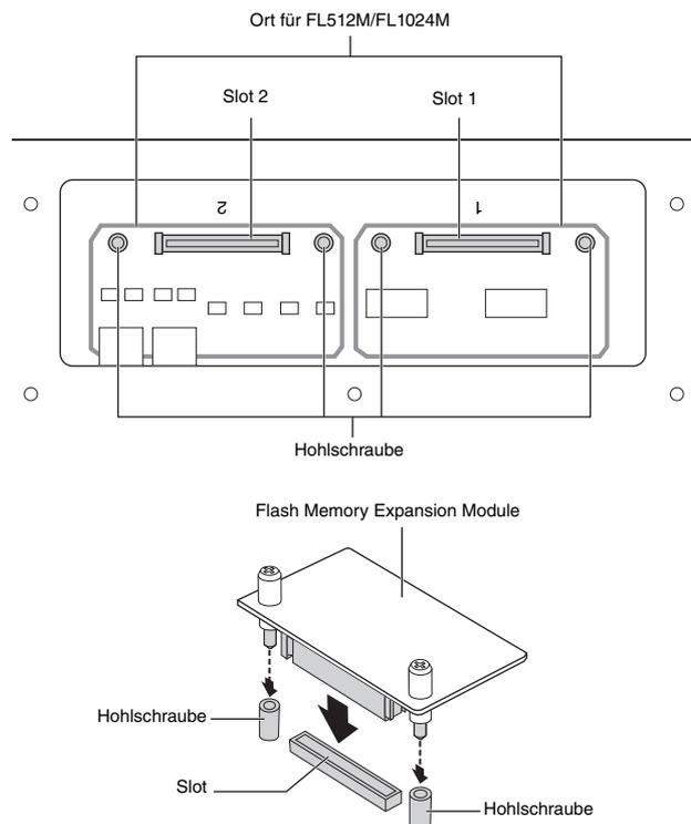
Befestigen Sie das Modul mit den folgenden Schritten in einem der Slots.
