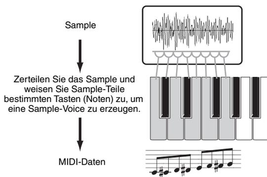
**HINWEIS** Bevor Sie den Slice-Vorgang ausführen können, müssen Sie die Länge des Samples genau einstellen, indem Sie den Endpunkt anpassen.
