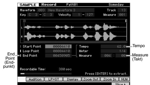
**13** Drücken Sie die Taste [SF2] ein- oder zweimal, bis LP=ST angezeigt wird.
