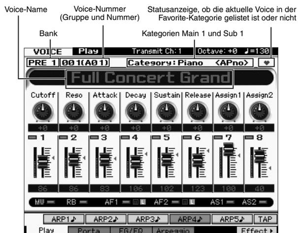
**HINWEIS** Das obige Display erscheint, wenn in der Zeile VOICE (in dem Display, das über [UTILITY] → [F1] General → [SF2] Screen aufgerufen wird) Type auf „1“ und Name Position auf „TOP“ gestellt ist. Diese Parametereinstellung können Sie durch Drücken einer der Cursor-Tasten bei gehaltener [EXIT]-Taste ändern. Mit diesem Bedienungsvorgang können Sie eines von vier Erscheinungsbildern des MOTIF XF abrufen.
