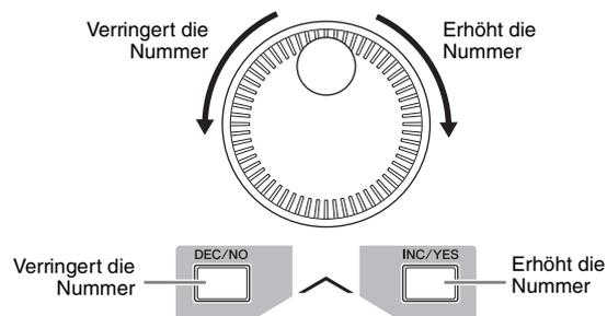
**HINWEIS** Mit der Taste [DEC/NO]/[INC/YES] oder dem Datenrad können Sie, wenn Sie den Cursor auf die gewünschte Position bewegt haben, den Wert verschiedener Parameter sowie die Song-Nummer ändern. Diese grundlegende Bedienungsweise wird für sämtliche Auswahl- und Einstellvorgänge am Instrument verwendet.
