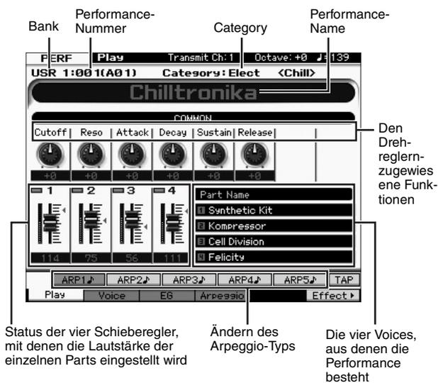
**HINWEIS** Das obige Display erscheint, wenn Type im Display [F6] Screen des Utility-Modus auf „1“ eingestellt ist. Diese Parametereinstellung können Sie durch Drücken einer der Cursor-Tasten bei gehaltener [EXIT]-Taste ändern. Mit diesem Bedienvorgang können Sie eines von vier Display-Designs des MOTIF XF abrufen.
