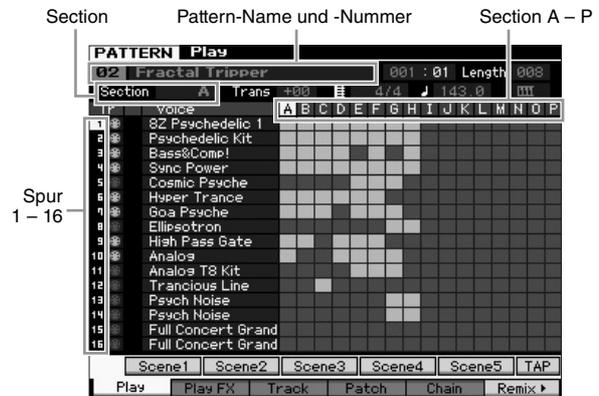
**HINWEIS** Wie im Pattern-Play-Display angezeigt besteht ein Pattern aus 16 separaten Spuren. Dementsprechend wird ein Pattern mittels der verschiedenen Instrumenten-Voices wie Bass, Gitarre und Klavier/Flügel wiedergegeben.
