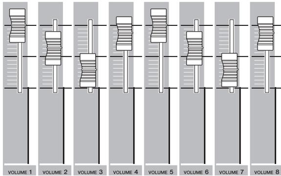
Wenn momentan eine der Spuren 1–8 ausgewählt ist, werden die acht Schieberegler dazu verwendet, die Lautstärke der Parts 1–8 einzustellen. Ist eine der Spuren 9–16 ausgewählt, so stellen die Schieberegler die Lautstärke der Parts 9–16 ein. Die Spur kann durch Einschalten der [TRACK]-Taste und Drücken der gewünschten Nummerntaste ausgewählt werden.
