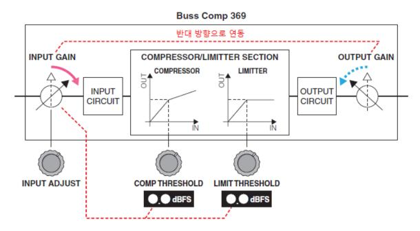
임계값이 크게 변경되기 때문에 표시된 값이 동시에 변경됩니다. 그러나 COMPRESSOR/LIMITER SECTION의 내부 상태는 변경되지 않습니다.
