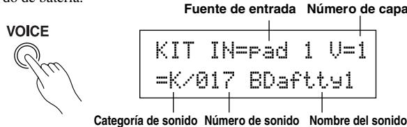
Utilice los botones [SEL◀]/[SEL▶] para desplazar el cursor hasta la posición de fuente de entrada y luego utilice los botones [VALUE-]/[VALUE+] para seleccionar “Pad 2”. Esto significa que queda seleccionada la entrada del pad de la caja que está conectada al jack de entrada de trigger 2 SNARE (CAJA).
