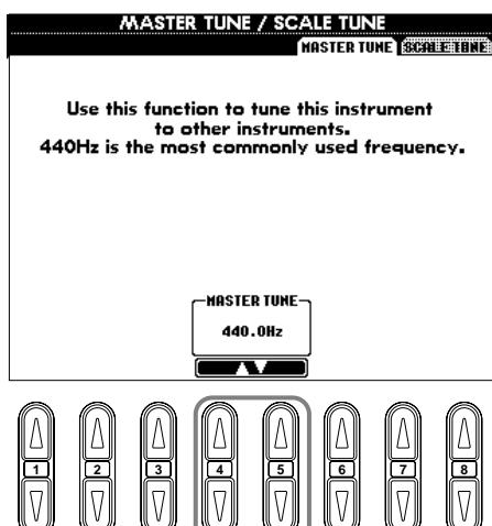
Determina el tono global del PF-1000, desde 414,8 a 466,8 Hz. Presione los botones 4 o 5 [▲▼] a la vez para restablecer automáticamente el valor de fábrica: 440 Hz.
