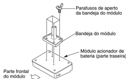
2. Posicione a bandeja do módulo dentro da garra do suporte e aperte o parafuso da garra para fixar a posição.
