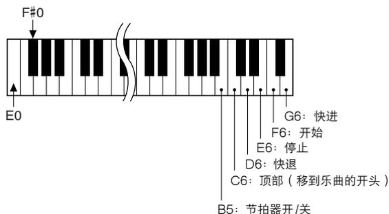
PSR-295: 要使用远程控制功能, 请同时按住键盘上最低的两个键 (C1和C#1), 然后按相应的键 (如下图所示)。
