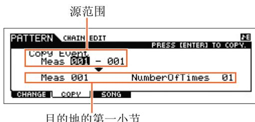
在此画面中，您可将指定小节（源数据）范围中的所有模板链事件复制到目的地位置。在指定了各小节中的源范围、目的地位置的第一小节和“NumberOfTimes”（复制数据的次数）之后，按[ENTER]按钮执行复制操作。
