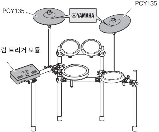
심벌즈 패드의 내장 센서는 상단 표면의 Yamaha 로고 가까이에 위치해 있습니다. 패드의 성능을 최상으로 발휘하려면 로고 주변 부분을 사용자가 쉽게 칠 수 있는 위치로 하여 패드를 배치해야 합니다. (위의 그림 참조)
