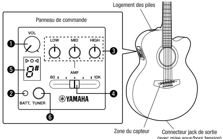
Le préamplificateur intégré est automatiquement mis sous tension lorsqu'un câble est branché dans la prise jack de sortie de la guitare. L'accordeur peut être mis sous ou hors tension à n'importe quel moment.
