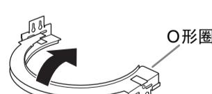
3. 通过将附带的2个螺丝拧入2个O形圈的凹槽固定O形圈和导轨。
