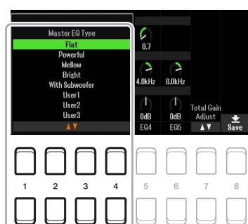
**Flat (Plat)** : réglages d'EQ plats. Le gain de chaque fréquence est réglé sur 0 dB.
