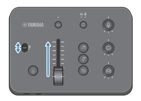
您可使用 Yamaha ZG Controller 檢查麥克風的輸入/輸出音量。檢查「MIC SETTINGS」畫面上的音量表,同時調整輸入音量(MIC LEVEL)和輸出音量(OUT LEVEL),確保音量在「OK」範圍內。
