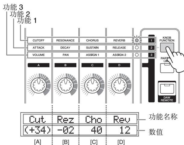
注 在按住 [SHIFT] 的同时按 [KNOB FUNCTION] 可将旋钮 [A] - [D] 快速重设到功能 1。
