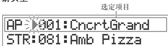
这个闪烁的三角形光标表示选定的项目行。使用光标 [^]/[v] 按钮可将光标向上或向下移动。
