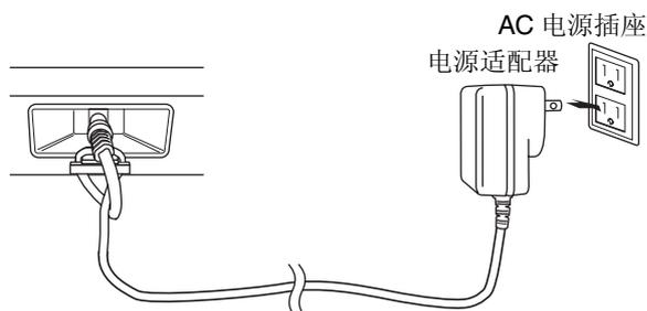
注 断开电源适配器的连接时，请将上述顺序颠倒执行即可。
