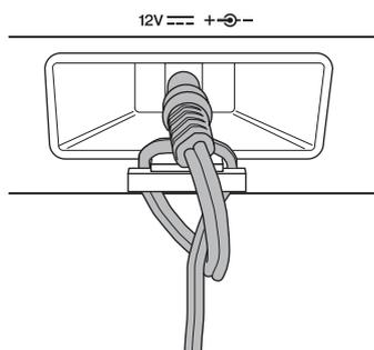
注 使用线夹可防止操作过程中连接线意外松脱。将连接线绕在线夹上时，请勿将连接线绷得过紧或用力拉拽，以防造成连接线磨损或线夹损坏。
