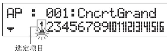
这个闪烁的下划线表示选定项目。此显示实际带有2种光标指示：下划线型和闪烁型。在此画面中使用光标 [^]/[v] 按钮可移动闪烁型光标，使用 [<]/[>] 按钮可移动下划线型光标。
