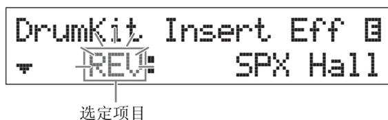
选定项目本身闪烁。使用光标 [^]/[v]/[<]/[>] 按钮可将光标指示上/下/左/右移动。
