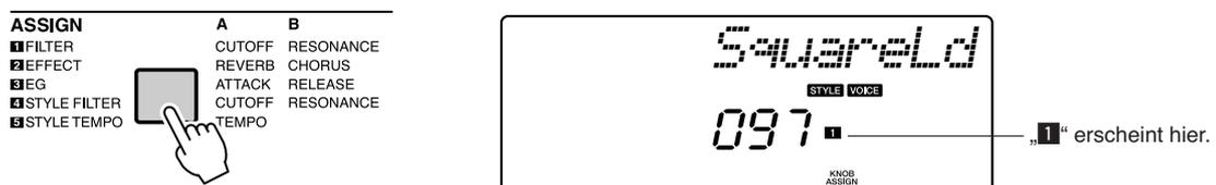
Nun kann Regler A verwendet werden, um die Filter-Grenzfrequenz zu ändern, und mit Regler B können Sie die Resonanz einstellen.
