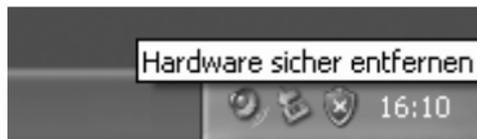
3. Wählen Sie [USB-Massenspeichergerät] und klicken Sie auf [Stop].
