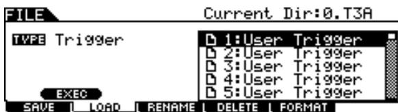
**5** 将光标移动到需作为载入源的触发器设置处，然后按 [SF1] EXEC 按钮。
