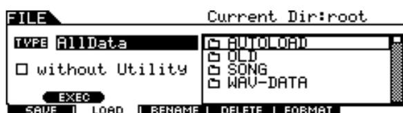
**3** 将光标移动到 TYPE 参数，然后使用数据轮或 [INC/YES] 和 [DEC/NO] 按钮将文件类型设定为“ AllData ”。
