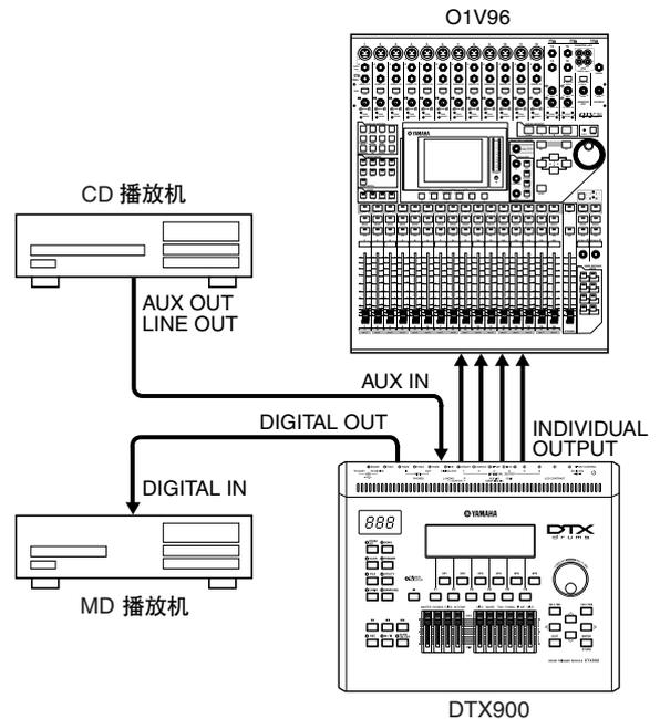
无论是否连接了耳机，OUTPUT (L/MONO 和 R) 和 INDIVIDUAL OUTPUT (1 到 6) 插孔都会产生线路电平音频信号。这些插孔为单声道耳机型插孔。若要通过这些插孔进行音频连接，请在 DTX900 上使用带有单声道耳机插头的电缆，并在其它设备上使用正确的插头。
