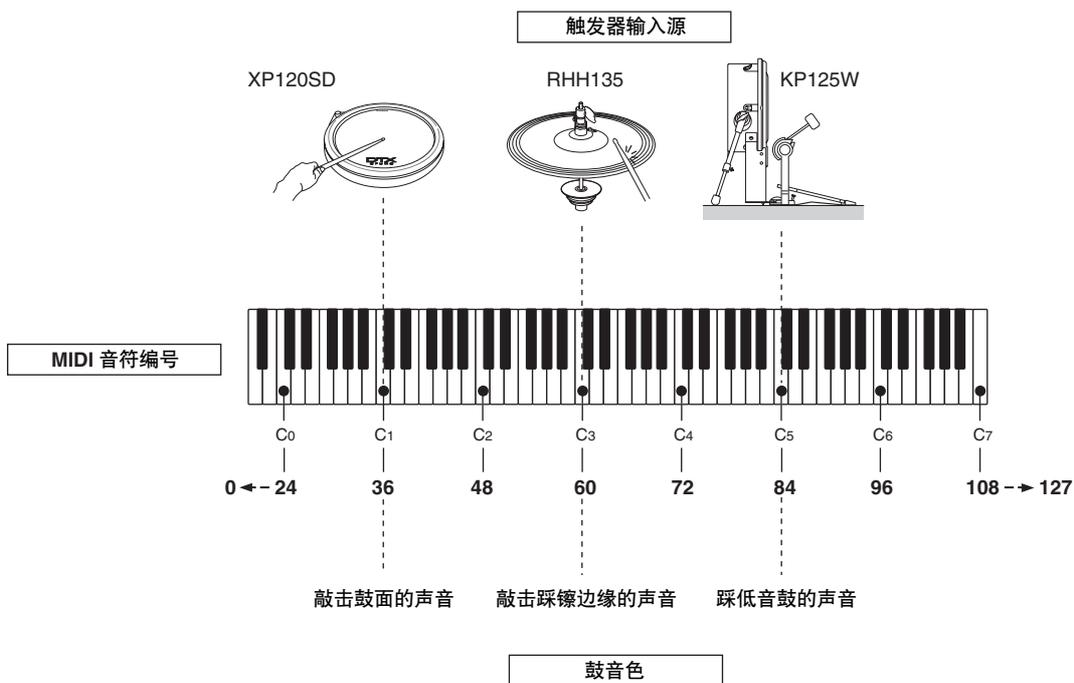
在上述示例中，下表中列出的触发器输入源和鼓音色被分别分配到 MIDI 音符编号 C1、C3 和 C5。
