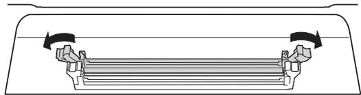
**4-2** 将 DIMM 垂直插入插槽。将 DIMM 牢牢压入，直至其“咬合”或锁定到位。
