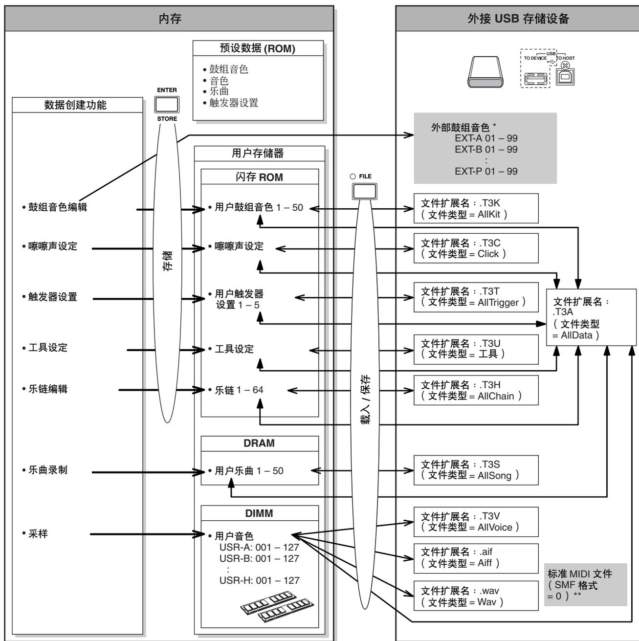
\* 存储在 USB 存储设备的根目录中的外部鼓组音色可直接在鼓组音色模式中调用，无需在文件模式中执行载入操作。当将鼓组音色存储到外部库时，将自动创建文件（扩展名：.T3E）。请勿更改文件名。
