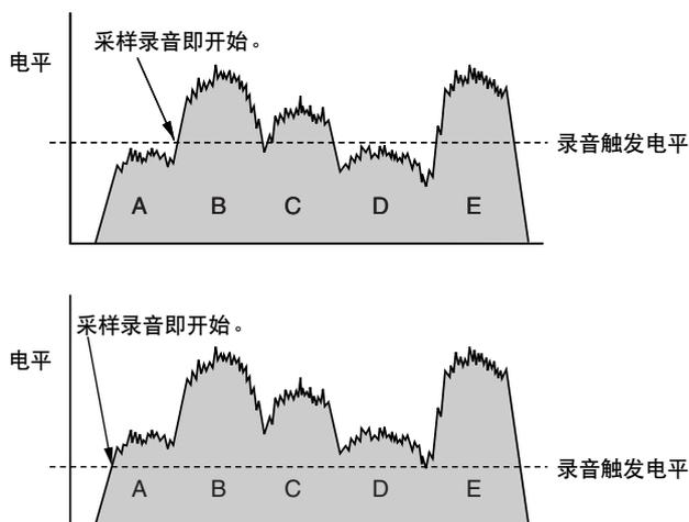
就像您看到的那样，触发电平设定的越高，输入音频音量需要越大才能启动采样。另一方面，如果触发电平设定得过低，则较低的噪音可能会意外启动采样。
