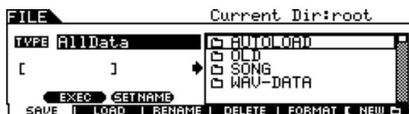
**3** 将光标移动到 **TYPE** 参数，然后使用数据轮或 [INC/YES] 和 [DEC/NO] 按钮将文件类型设定为 “AllData”。
