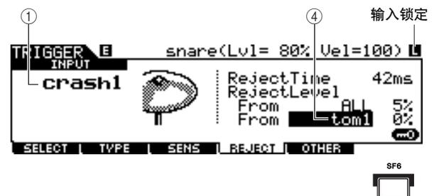
2. 调节 Reject Level From 的 “tom1” 数值，使得即使敲击与 TOM1 插孔相连的打击垫，也不会触发 Crash1 声音。数值越高，则 Crash1 声音被意外触发的可能性就越低。
