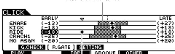
此横杠表示容许范围（在此节拍点范围内可发出声音）。此横杠与 Groove Check 画面中的横杠不同，其表示您的所有实际敲击的节拍点范围。
