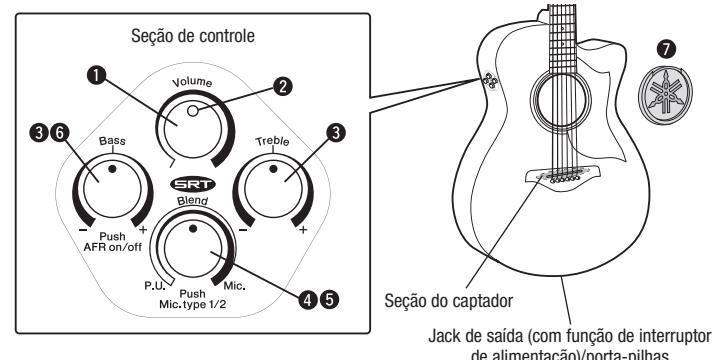
O pré-amplificador integrado é ligado automaticamente quando o cabo do violão for conectado ao jack de saída. Sempre ajuste o volume para o seu nível mínimo ao conectar ou desconectar o cabo.
