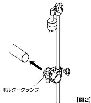
3. クランプボルトを締めてシンバルホルダーを固定します。
