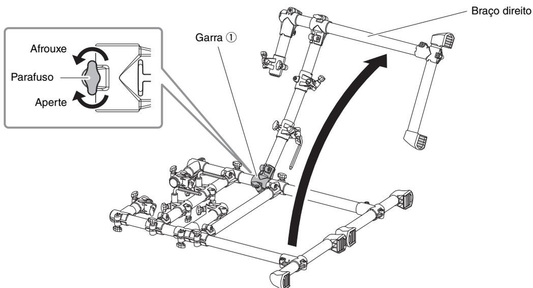
2. Coloque a estrutura principal em uma superfície plana e nivelada. Se a estrutura principal erguida oscilar quando você agitá-la, verifique se há parafusos frouxos e aperte-os.
