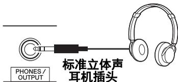
使用[PHONES/OUTPUT]（耳机/输出）插孔连接耳机。此插孔也可用作外接信号输出。通过与计算机、键盘功放、录音器或其他音频设备相连，您可以将本乐器的音频信号输出至外接设备。将插头插入此插孔后，本乐器的扬声器将自动关闭。
