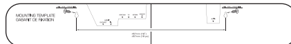
取付用テンプレート ※ 本機を壁に設置するときに使用します。
