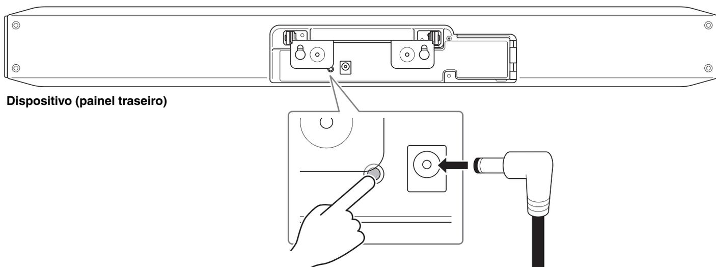
Conectar o cabo de alimentação liga automaticamente o dispositivo.
