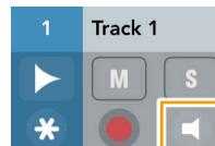
本体のダイレクトモニター機能を使わず、Cubasis LE 3 を通した音をモニターしながら録音をする場合は、モニタリングをオン (点灯) にしてください。
