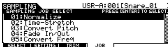
**3** Mueva el cursor hasta la tarea deseada con el dial de datos, los botones [INC/DEC] y [DEC/NO], o con los botones de cursor hacia arriba y hacia abajo y, a continuación, pulse el botón [ENTER/STORE].
