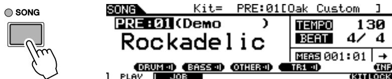
**3** Pulse el botón [F6] KITLOCK para que se muestre el indicador "L" en la parte superior derecha de la pantalla.
