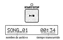
Nota: Cuando pulse la tecla START/STOP, el MDF3 "dudará" entre 1 y 15 segundos mientras lee los datos del disco antes de comenzar a reproducirlos. Si necesita comenzar la reproducción con mayor precisión, pulse la tecla PAUSE inmediatamente después de pulsar la tecla START/STOP, y espere a que se ilumine el indicador de START/STOP. El MDF3 empezará a reproducir el archivo tan pronto como se pulse la tecla PAUSE por segunda vez o se accione el pedal conmutador (si está conectado).
