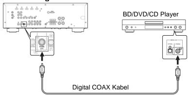
Die Bilder zeigen Beispiele für die Verbindung, Abhängig vom verwendeten Player mit digital Ausgang. Verbinden Sie entweder optisch oder koaxial.
