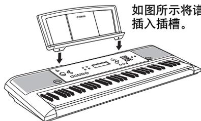
如图所示将谱架插入插槽。
