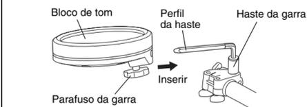
3. Se for necessário, use os parafusos das garras de A até D para ajustar a altura e o ângulo de qualquer bloco. Ao fazer isso, ajuste um parafuso por vez (isto é, afrouxe um parafuso, ajuste o bloco e, depois, aperte-o novamente antes de afrouxar outro).
