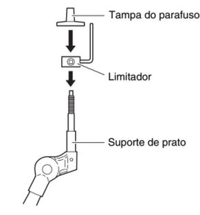
\* Ao montar a tampa do parafuso, gire-a até ficar fixa na posição.
