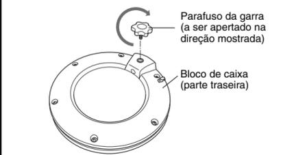
2. Monte o bloco de caixa na haste da garra do rack. Como mostrado abaixo, verifique se o perfil da haste está totalmente inserido no orifício de montagem do bloco e, depois, aperte firmemente o parafuso da garra.
