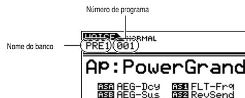
Existem oito secções de memória diferentes para as vozes normais (página 24): PRE 1-5, GM e USR 1-2. Para as vozes de bateria é possível seleccionar entre três secções de memória diferentes: PRE, GM e USER. Se estiverem instaladas as placas Plug-in, poderão ser seleccionados os bancos PLG1 e PLG2.
