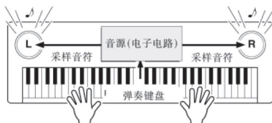
根据键盘上的弹奏信息,一个存储在音源中的采样音符通过扬声器发出声来。
