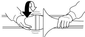
Como se muestra en la ilustración, sostenga el pabellón del instrumento con la mano izquierda y, mientras gira la Pickup Mute™, insértela firmemente en el pabellón con la mano derecha.
