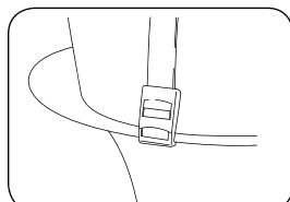
4. Enganche los ganchos de sujeción de la PM1 al pabellón, ajuste la longitud (tensión) de la correa de los ganchos.
