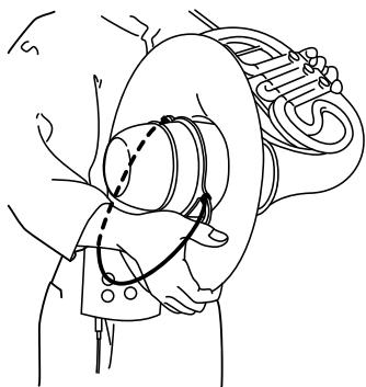
Como se muestra en la ilustración, sostenga ligeramente el asa de la parte intermedia de la Pickup Mute™, con la yema del dedo pulgar mientras sostiene el instrumento por el reborde del pabellón con los otros dedos.
