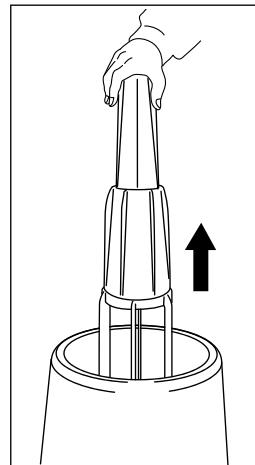
3. Extienda por completo el cabezal interior, que está situado en el centro del cabezal.
