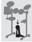
2. 如下图所示将底座装到支架上，然后从底座侧装配步骤 1. 中拆下的翼形螺栓、弹簧垫圈和平垫圈并固定到位。
