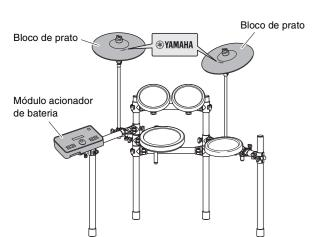
O sensor interno do bloco do prato está localizado próximo do logotipo da Yamaha na superfície superior. Para obter o melhor desempenho do bloco, posicione-o de forma que a área em torno do logotipo possa ser facilmente atingida. (Veja a figura acima.)
