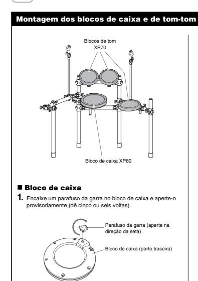
**2.** Empurre o bloco de caixa no suporte de caixa do rack. Verifique se a seção da haste está totalmente inserida no orifício de montagem do bloco de caixa e aperte o parafuso da garra para prender o bloco no lugar.
