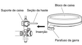
**3.** Solte os parafusos de A a D conforme mostrado abaixo para ajustar a altura e o ângulo do bloco de caixa. Quando posicionados corretamente, reaperte bem os parafusos antes de seguir para a próxima etapa.
