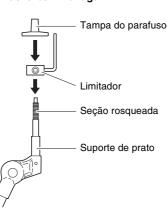
**5.** Quando o limitador estiver totalmente em contato com a superfície inferior da tampa do parafuso conforme mostrado abaixo, aperte o parafuso da chave do limitador com a chave
