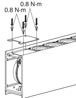
（限 VXL1-8）将端口区块插到低音反射端口中，然后对齐端口盖并使用拆下的螺丝将其拧紧到位。
