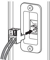
室外安装时，请安装随机附带的终端接线盖。
