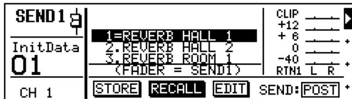
**!** Bitte beachten Sie, daß sich beim Drücken eines SEND-Tasters die Funktion der Schieberegler ändert. Dann dienen sie nämlich zum Einstellen des Effekthinwegpegels. Wenn Sie den Pegel eines Kanals regeln möchten, müssen Sie die SEND LCD-Funktion wieder verlassen.
