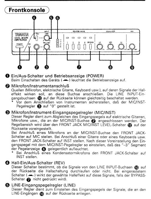
Bei Anschluß von Quellen an den LINE INPUT-Buchsen auf der Rückseite zunächst den Eingangspegel mit dem –10dB/–20dB-Schalter () vorwählen und dann den Eingangspegel mit diesem Regler so einstellen, daß das "–3" Segment der Pegelanzeige () gelegentlich aufleuchtet.
