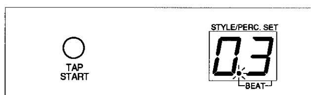
2. Frapper n'importe quel tampon de percussion ③ suivant une mesure régulière en utiliser le rythme auquel l'interprétation doit être faite. L'ensemble DD-8 opèrera un comptage de "un, deux, trois, quatre !" (ou une variation en fonction de la signature temporelle du style qui a été sélectionné), puis commencer à jouer l'accompagnement rythmique automatique suivant le rythme auquel il a été réglé.
