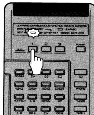
4. 最初に操作したい信号(例えばアンプの電源ON)が入っている記憶可能キーを押します。LEARNEDインジケーターがしばらく点灯します。
