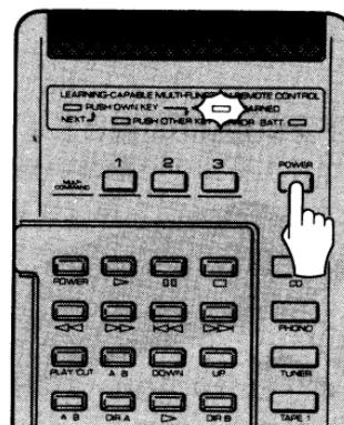
5. PUSH OTHER KEY インジケーターが再び点灯したら、次に操作したい信号(例えばビデオデッキの電源ON)が入っている記憶可能キーを押します。
