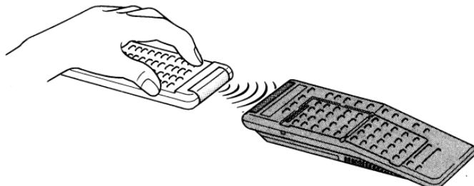
相手のリモートコントローラーからの赤外線を受信すると PUSH OTHER KEY インジケーターが点灯に変わります。このインジケーターが消えるまで、リモートコントローラー上のキーは押し続けてください。
