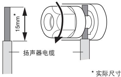
请勿让裸露的电线头伸出端子孔并碰到底盘。下图所示为正确连接的电缆外观。
