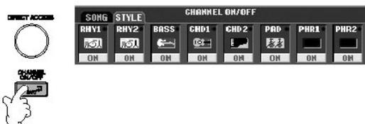
2. Pressione os botões [1▼]–[8▼] para acionar os canais. Para escutar só um instrumento, pressione e segure o botão apropriado para o canal ser fixado em SOLO. Para cancelar SOLO, aperte simplesmente o botão do canal apropriado novamente.
