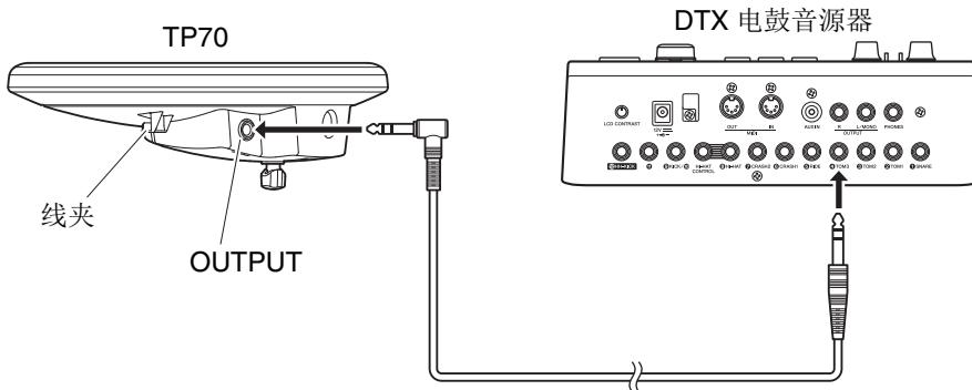
**注** 为了保护连接线和插孔不受损坏，请务必将连接线缠绕到线夹上。
