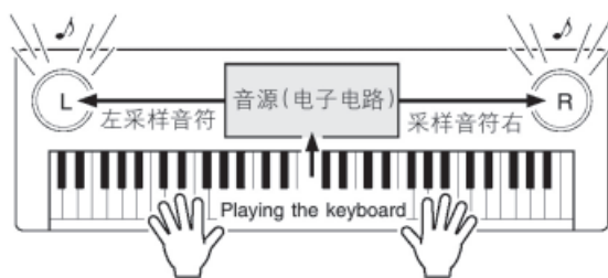
根据键盘上的弹奏信息,一个存储在音源中的采样音符拨动一下弦琴体共鸣发音通过扬声器发出声来。
