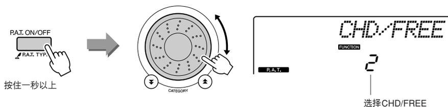
按住[P.A.T. ON/OFF]（节拍器开/关）按钮达一秒以上。此时画面上将出现“PAT Type”字样几秒钟，随后显示当前所选的演奏助手功能的类型。使用数据盘选择CHD/FREE型。
