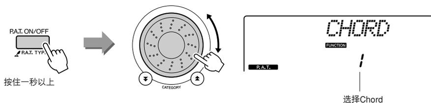
按住[P.A.T. ON/OFF]（节拍器开/关）按钮达一秒以上。此时画面上将出现“PAT Type”字样几秒钟，随后显示当前所选的演奏助手功能的类型。使用数据盘选择Chord（和弦）类型。
