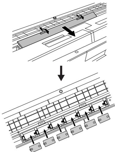
使用电池供电时，本乐器要求使用六节1.5V“D”型R20P（LR20）或等效电池。（建议使用碱性电池。）如果电池电量太低不足以维持正确操作时，请务必立即更换所有电池，遵守下述注意事项。
