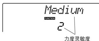
**3** 在键盘力度响应时用数据盘在1和3之间选择一个力度灵敏度设置。所选的值越高，键盘力度响应时的音量变化就越大（越容易）——也就是说，灵敏度越高。
