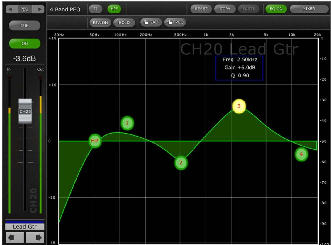
Le nom, la couleur, le fader, les indicateurs de niveau et les touches [ON] et [CUE] associés au canal actuellement sélectionné s'affichent dans la colonne de gauche. Des touches fléchées apparaissent dans le coin inférieur gauche, qui permettent de naviguer entre les différents canaux « précédent » et « suivant ».
