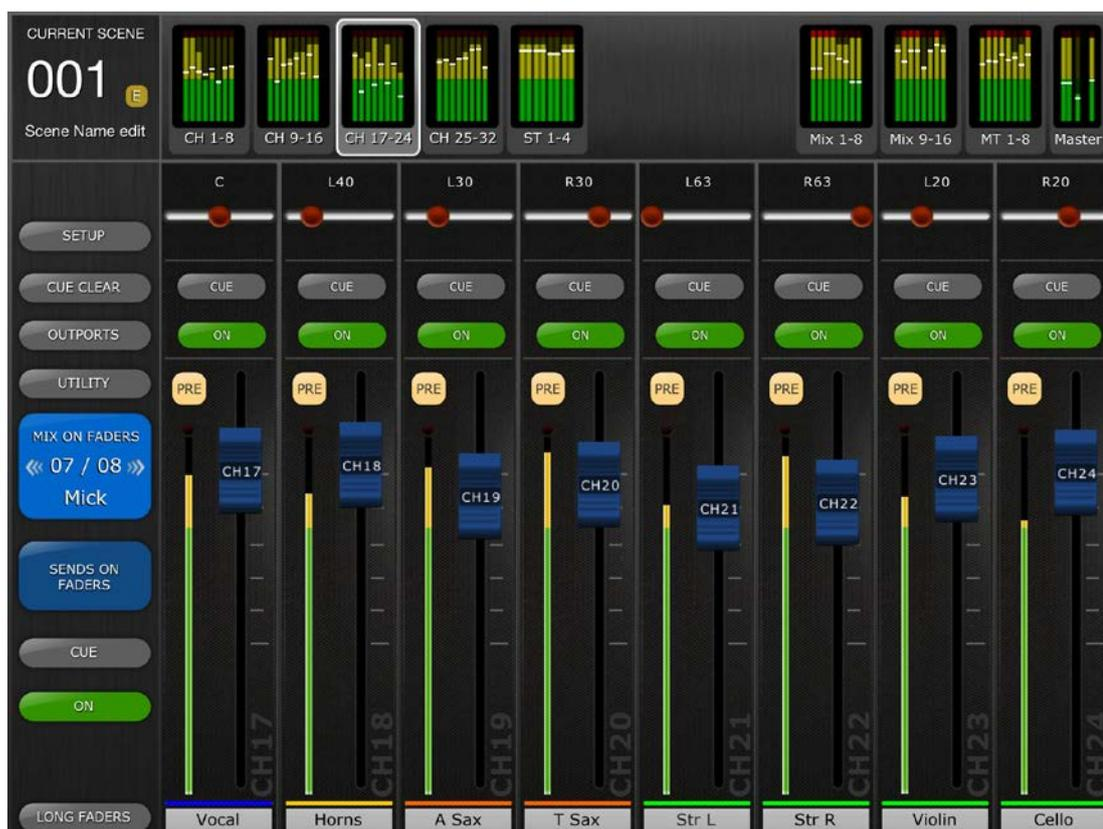
Une large touche [MIX ON FADERS] (Mixage de faders activé) affiche le numéro et le nom du bus Mix ou Matrix actuellement sélectionné. La couleur de cette touche correspond à celle des touches utilisées sur la console LS9.
