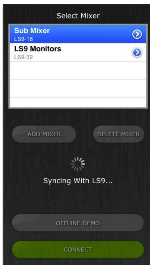
Le message « Syncing With LS9... » (Synchronisation avec console LS9 en cours...) apparaît alors que StageMix tente d'extraire les paramètres de la console. Une fois le processus terminé, la fenêtre de la console de mixage apparaît et l'application StageMix est prête à l'emploi.
