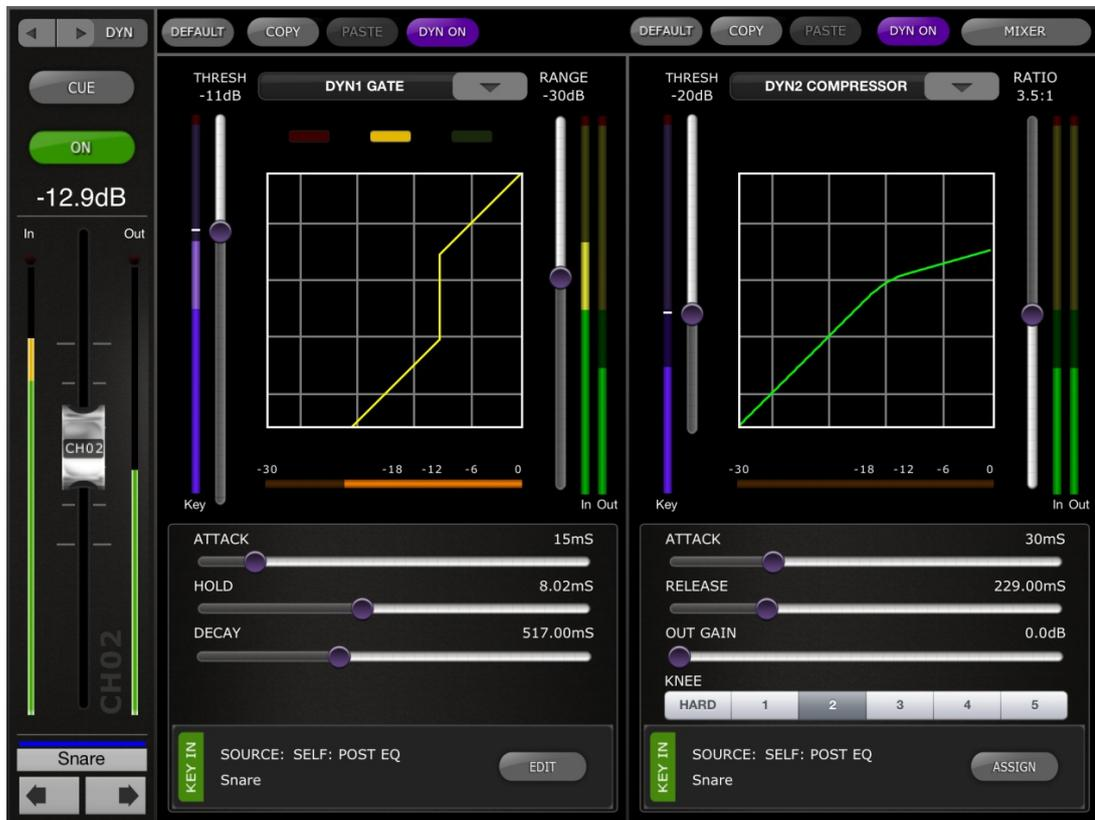
Le volet gauche de cet écran (Channel Strip) est identique à l'écran EQ Editing (Édition de l'EQ), étant doté des mêmes éléments : fader de canal, touche On (Activation), touche Cue, indicateurs de niveau d'entrée et de sortie, nom de canal, et touches de couleur et de navigation.
