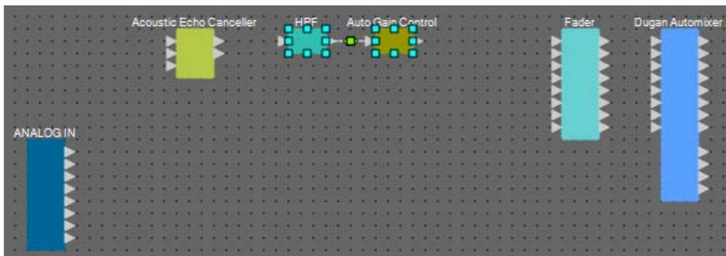
**4. Kopieren Sie die ausgewählten Komponenten und Kabel und fügen Sie sie einmal ein, oder ziehen Sie die ausgewählten Komponenten und Kabel bei gehaltener <Strg>-Taste und legen sie ab.**
