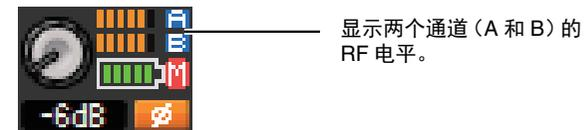
显示两个通道 (A 和 B) 的 RF 电平。
