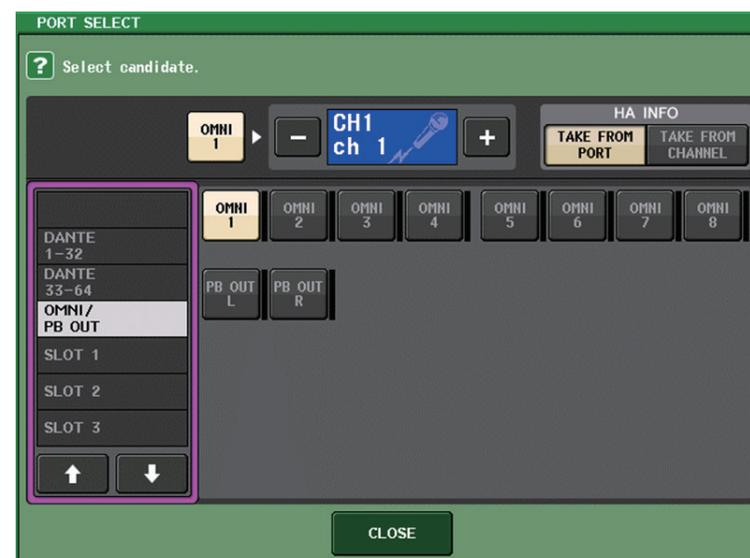
这可以将输出信号从 AXT400 分配至输入通道，同时可以从输入通道控制和监听 AXT400 的电平。
