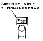
フェーダー 1  $\sim$  8 が、①の操作で指定した系統のフェーダーとなる。たとえば、①の操作でSEND2を押していたなら、フェーダー 1  $\sim$  8 は、左から順に、チャンネル 1 のCH EFFECT SEND 2 LEVEL, チャンネル2のCH EFFECT SEND 2 LEVEL,…のようになる。
